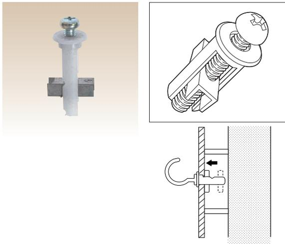
**特徴** 材質はナット部がベリック（高強度合金）で、ねじれなどに対する強度が優れている。樹脂部分はポリエステル。ボルト部は鉄でユニクロメッキ。中空壁内で反転ナットが回転する構造。
