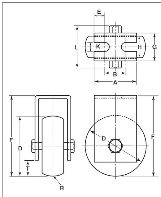
※枠、軸の材質はSUS304、車の材質はSUS303です。
