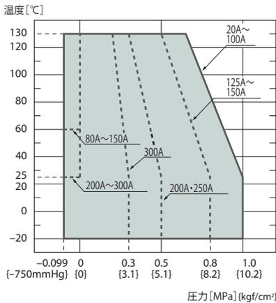
●最高使用圧力・最高使用温度が使用範囲内であることを確認の上で使用ください。
