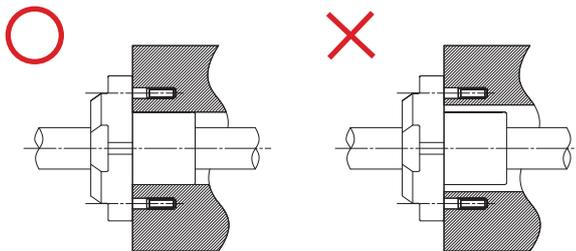
図1 外筒インロー取付け
