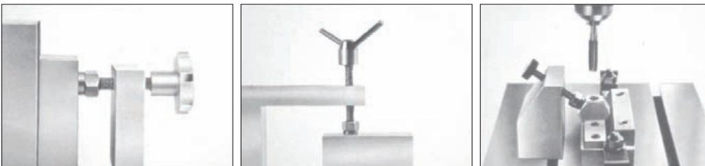
このナットは、加工時に治工具、機械等の取付ねじ、押付ねじ、締付ねじ等の先端にはめ込んでください。
