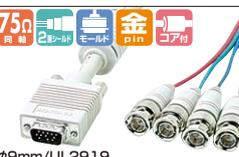
75Ω<br>2芯シールド<br>モデル<br>金ピン<br>コア付<br>φ9mm/UL2919<br>ミニD-sub(HD)15pinオス インチネジ(4-40)<br>フレーム<br>シールド<br>フレーム<br>BNCオス×5<br>ストレート全結線 | 4969887 512524 | T4       |
