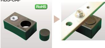
幅の広いブスバーを支持する場合は、上図のように専用キャップをご使用いただき ますと、絶縁距離が確保できます。
