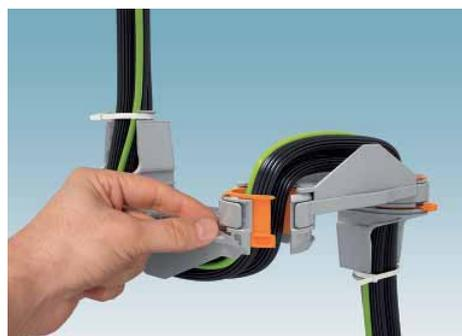
制御盤の本体とドアをつなぐ電線類を、スマートにまとめるCGSケーブルガイドシステム。CGS 50は、可動部を開ければ横から電線が挿入可能。カバーは脱着可能。
