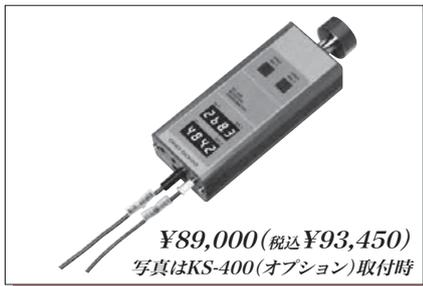
エレベータの調整、保守、点検用に設定された小型・軽量、乾電池駆動のハンディタイプの速度計です。計測はエレベータのロープが吊ってあるプーリに先端の周速リングを押し当てて行ないます。ホールドボタンまたは、外部信号によるホールドも可能ですのでガバナ検出スイッチ(オプション)を併用することによってガバナ動作時の速度を保持表示することができます。
