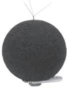
全天候型防風スクリーンを使用することで、屋外での騒音測定時に風による雑音の軽減、雨や雪などによるマイクロホンの損傷を防ぐことができます。
