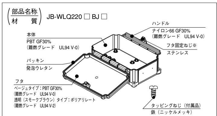
※ハイルーフトタイプ (JB-WLQ135HBJ-C)、JB-WLQ220HBJ-C) には、フタ固定ねじ部にスプリング (ステンレス) がつきます。
