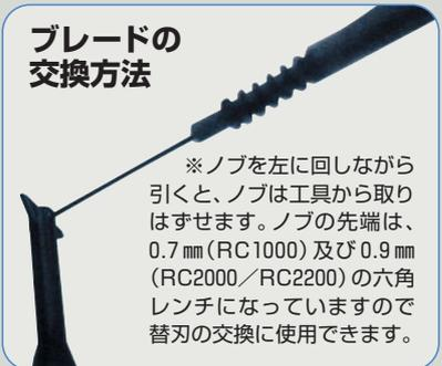
※ノブを左に回しながら引くと、ノブは工具から取りはずせます。ノブの先端は、0.7mm(RC1000)及び0.9mm(RC2000/RC2200)の六角レンチになっていますので替刃の交換に使用できます。
