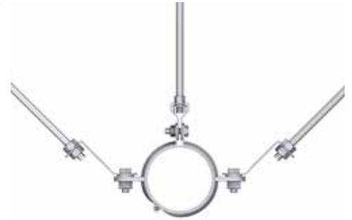
エースハンガーと振れ止め金具を接続し、5点(3点)を均等になるよう施工します。
