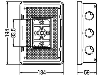
●配管後、ボックスにフリーボードを取り付け、4mmバー等で配筋に固定します。
