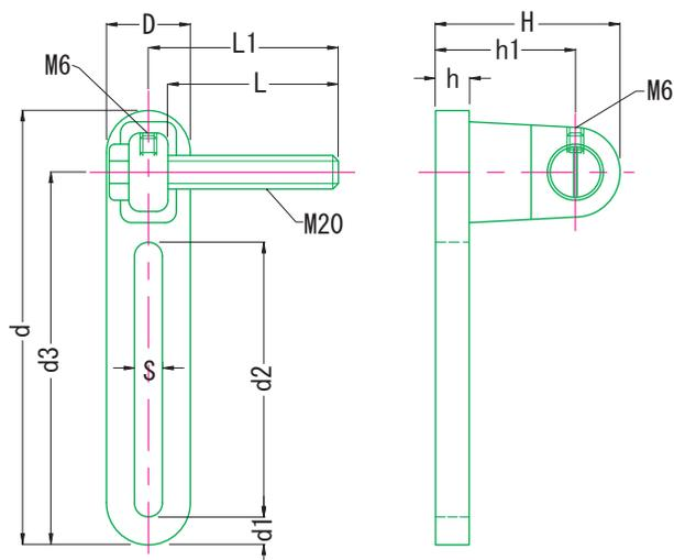
**材表** ボディー body : アルミニウムAC2B・シルバーハンマートン塗装
