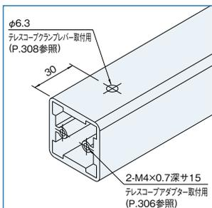
テレスコープクランプレバー又はテレスコープアダプターを取付ける為に、両端にM4×0.7深サ15、及びφ6.3の穴加工をしてください。
