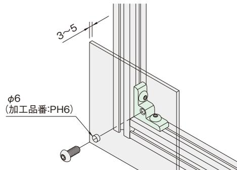
側面のタップ穴を使用し、t=3~5mmのパネルを取付けできます。
