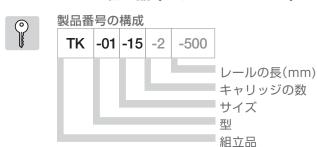
この注文例 (TK-01-15-2、500) は、サイズ15、キャリッジ2個、レールの長さが500mmのドライリンTー式を示しています。
