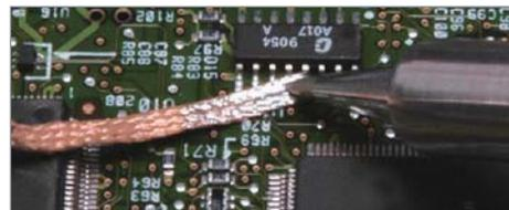
ハンダ吸取線をご使用の際は、30W以上のハンダゴテで加熱することをおすすめします。ただし、線幅0.9/1.3mmは熱容量の少ないハンダゴテでもお使いいただけます。
