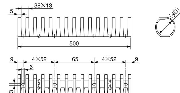
カバーが不要で、ケーブルの取り付け、取り外しが簡単な配線ダクトです。ビス止めタイプと、粘着テープ付きからお選びいただけます。ヘラダクトは、スリットが広いので、電線の識別や分岐が簡単に行なえます。また、通常の配線ダクトに比べ、コンパクトなデザインで、省スペース化に貢献します。配電盤、分電盤やオフィス家具等の配線にお使いください。
