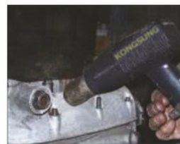
녹슨 볼트 및 나사를 느슨하게 함 Loosen Rusted Nuts & Bolts
