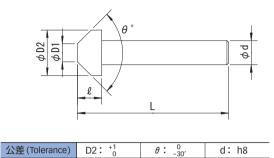
右刃ストレート  $\phi$ 60までSKH51  $\phi$ 65以上 SKH56 Straight Flute HSS-Co for  $\phi$ 65 and over. HSS for other Size.
