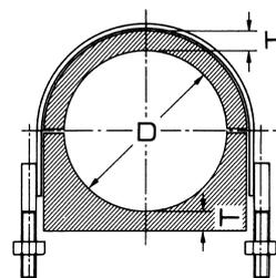
●製品の呼び方 タイプ—実寸 (D)—厚さ (T)—長さ (L)
