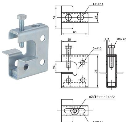
形鋼から吊ボルトをおろすための金具。スライド可動タイプ。
