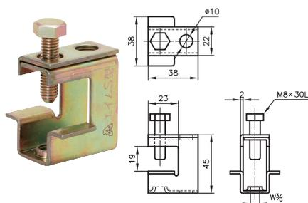
形鋼から吊ボルトをおろすための金具。軽量物用。固定タイプ。
